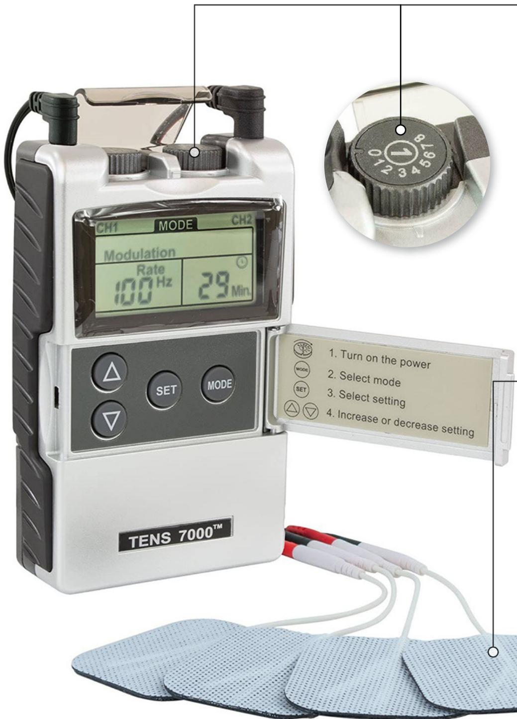
La intensidad de la potencia de estimulación, se maneja desde los mandos giratorios ubicados en la parte superior del dispositivo. Cada canal controla 2 electrodos, permitiendo una variación de 0 a 100 mA en incrementos de a 10 mA.
