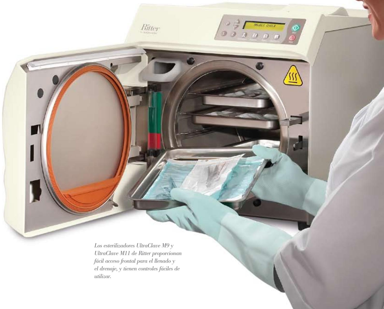
*Los esterilizadores UltraClave M9 y UltraClave M11 de Ritter proporcionan fácil acceso frontal para el llenado y el drenaje, y tienen controles fáciles de utilizar.*
